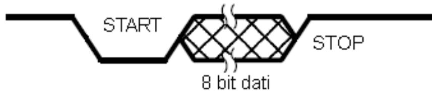
**Figura 4.10:** Tipica trasmissione secondo il protocollo RS232.
