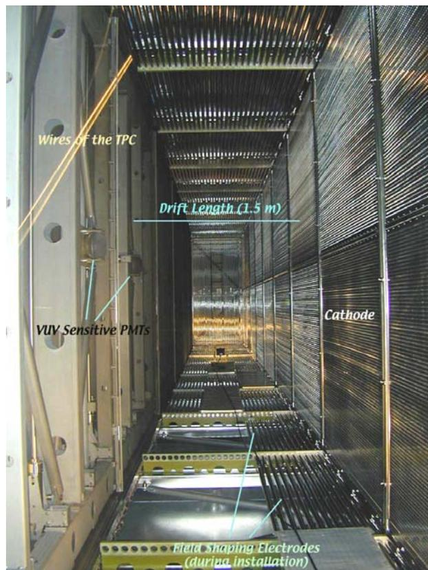
**Figura 2.4:** Foto dell'interno della camera sinistra di un T300
