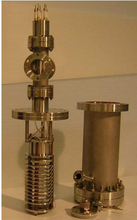
Figura 3.10: Foto del dewar contenente il monitor di purezza in Vetronite durante l'assemblaggio.
