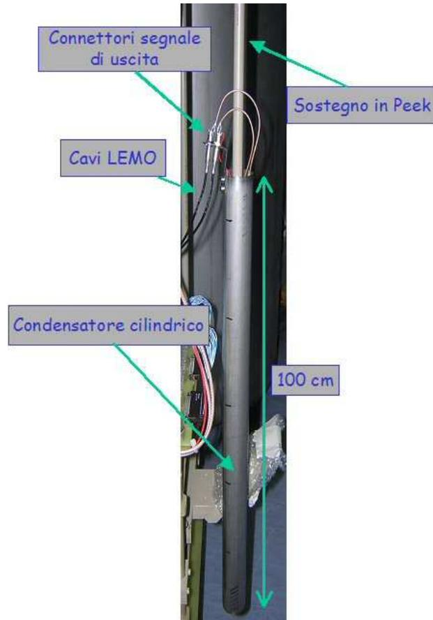
Figura 5.12: Foto del condensatore cilindrico che funge da misuratore di livello.
