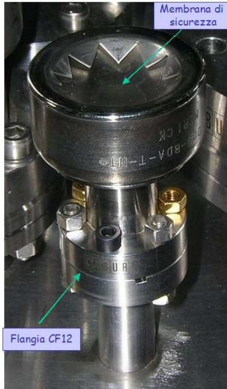
Figura 5.10: Foto del disco di rottura.
